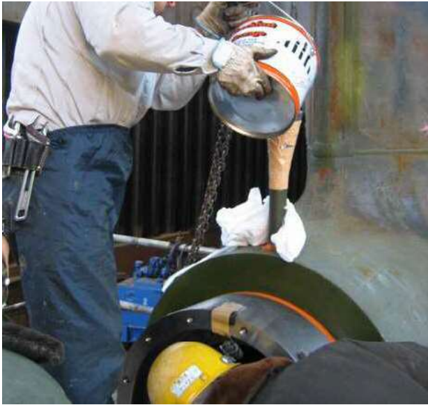
図2 船尾軸受けへのエポキシ樹脂流し込み
